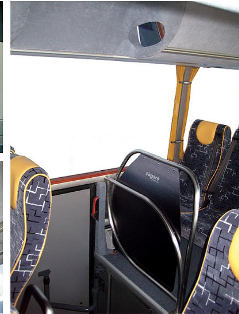
**Espejo de servicio** de fijación rígida y de gran visibilidad desde el puesto del conductor.
